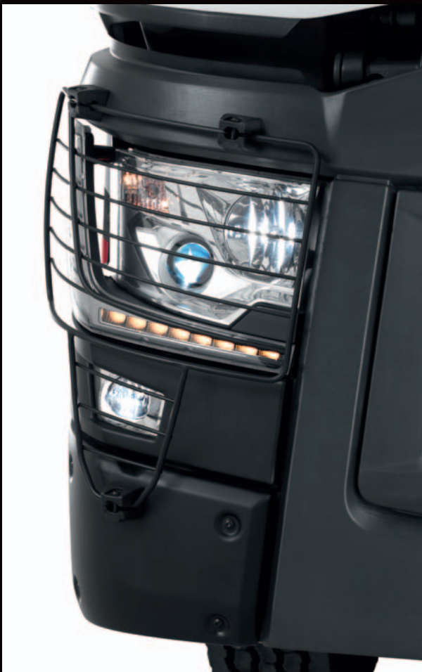
Scheinwerferschutzgitter und seitliche Stoßfängerecken aus Metall
